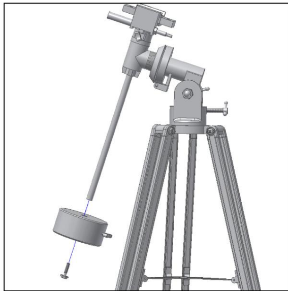
Figura 5. Infilare l'albero del contrappeso. Inserire il contrappeso.
