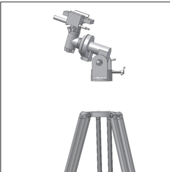
Figura 4. Posizionare la testa equatoriale sulla parte superiore del treppiede.
