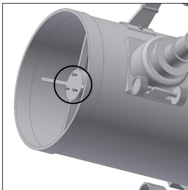
Figura 25. Viti di regolazione dello specchio secondario.
